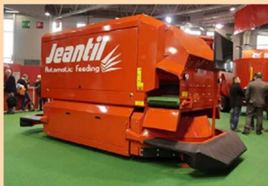
Commercialisé depuis deux ans, ce robot d'élevage va chercher la nourriture dans une cuisine automatique, chargée de préparer des rations, pour l'amener aux animaux.
