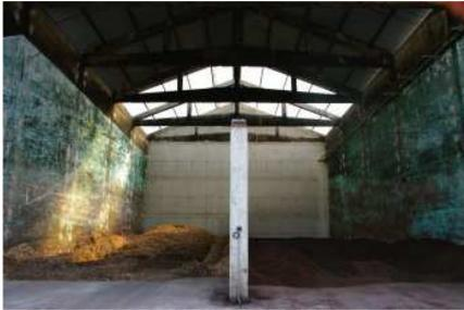
*Copeaux de bois de scieries et de charpentes de vignes (à gauche) et marc de pressoirs déshydraté (à droite) sont brûlés pour produire de la vapeur et alimenter la distillation.*
